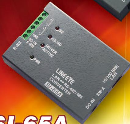
SI-65/SI-65A/SI-65FA/SI-65FA-Lは、RS-422/RS-485のシリアル通信ポートを持つFA機器や計測器などをLANネットワークに接続できるようにするインターフェース変換器です。
