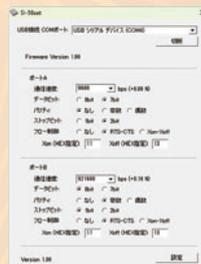
PCソフトSI-58setで、ディップスイッチでは設定できない特殊な通信速度(200bps~1Mbps)もUSB経由でパソコンから設定できます。PCソフトSI-58setはラインアイのホームページからダウンロード可能です。
