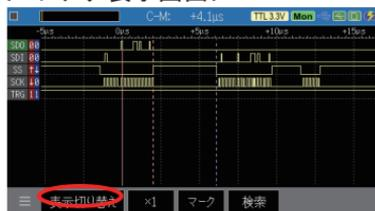
波形モニターを有効にして測定した時は、測定停止中に “表示切り替え” をタッチするとダンプ表示画面の次にタイミングモニター表示（ロジアナ表示）になります。
