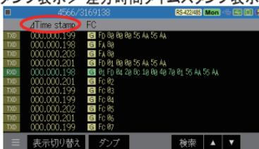
画面の“Time stamp”をタッチして、タイムスタンプ表示を切り替えられます。画面下の“ダンプ”をタッチして表示形式を切り替えることができます。
