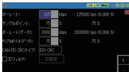
本機内蔵の通信速度発生回路で入力値に最も近い通信速度が設定されます。誤差が大きい場合は、正常にモニターできない可能性があります。
