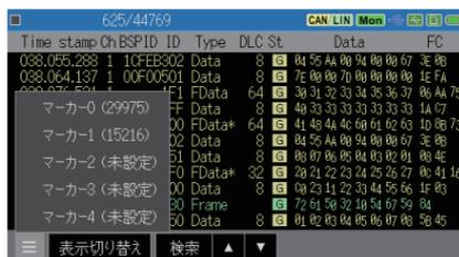
登録したマーカーへは [ マーカーに移動 ] をタッチし、ジャンプしたいマーカーを選択します。
