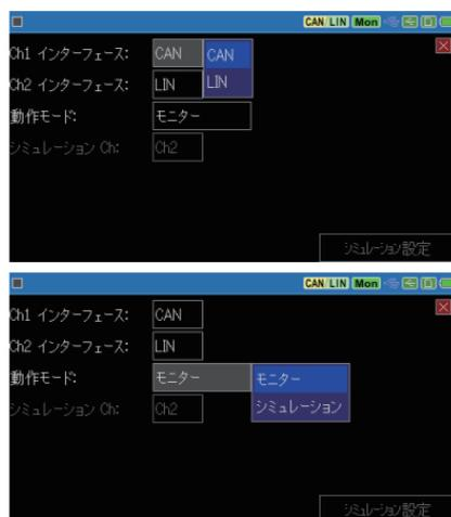
シミュレーションに必要な設定は [シミュレーション設定] をタッチして、プロトコル毎に必要な設定を行います。
