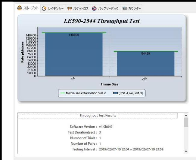
X 軸にフレーム数/秒、Y 軸にフレームサイズで DUT のスループット性能を表します。
