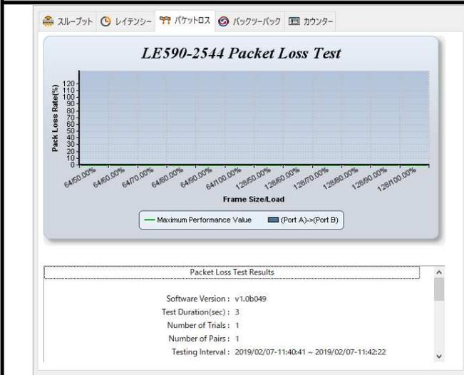
X 軸にパケットロス率(%)、Y 軸にフレームサイズ/負荷(%)を表します。
