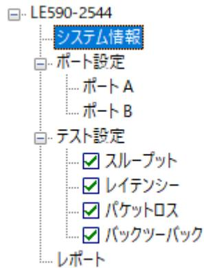
システム情報/設定リストでは、システム情報の表示、ポート/テスト設定、メイン画面でのテストレポートの確認ができます。
