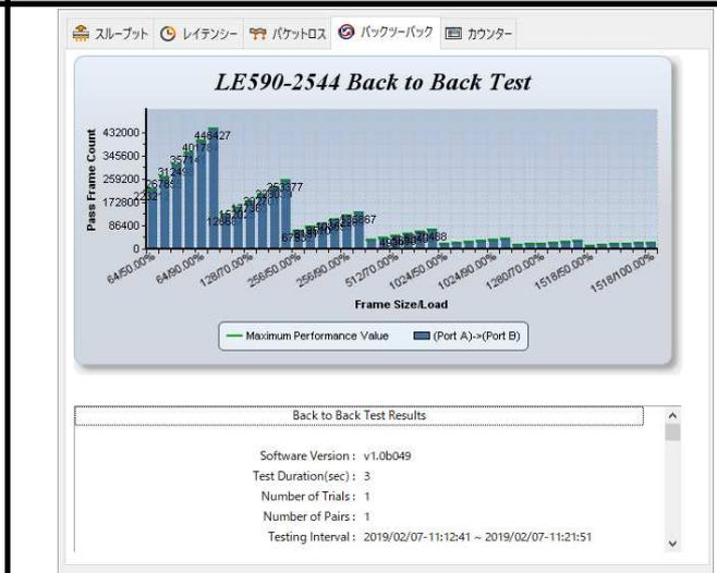
X 軸に Pass したフレーム数、Y 軸にフレームサイズ/負荷(%)を表します。
