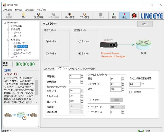
ステップ 4： 右上の実行アイコンをクリックし測定を開始します。試験結果はレポートにて表示されます。
