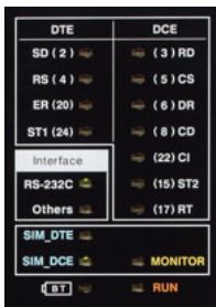
2色発光LEDで通信ライン状態をリアルタイム表示します。
