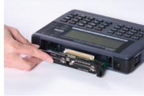
▲ハードウェア仕様の異なる新たな通信規格にも計測ボードの交換で対応できます。 ▲計測対象のコネクタ形状に応じた各種ケーブルや端子台アダプタが用意されています。
