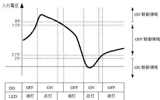
この例の場合、点灯領域側を優先するヒステリシス設定のため DO を ON するタイミングが LED 点灯タイミングに一致しますが、DO を OFF に戻すタイミングは LED の消灯よりもヒステリシス幅分だけ遅れます。DO を OFF にするタイミングを重視したい場合は、DL コマンドの HD ビットを HD=0(消灯優先)にしてください。
