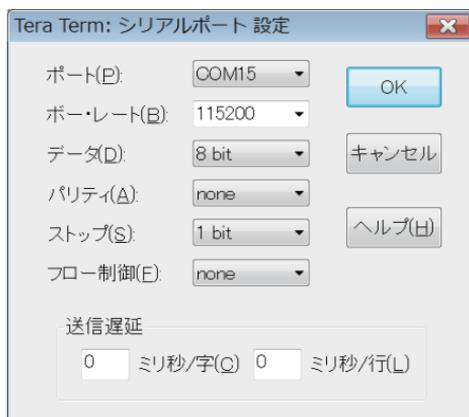
ポート (P) の設定は、USB- シリアル変換モジュールの COM ポート番号をパソコンのデバイスマネージャーで確認し、その COM ポート番号を選択してください。
