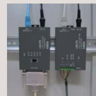
DIN rail mounting example
