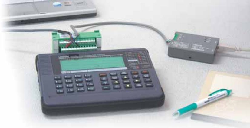
オプションのDSUB25ピン用端子台 (LE-25TB) を使用したRS-485信号の接続例
