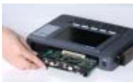
新たな通信規格に対応できる計測ボード交換方式
