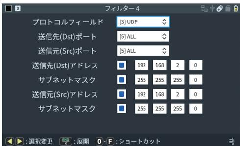
フィルター4で、送信元IP、送信先IPのネットワークアドレス部がいずれも「192.168.2」のフレーム (UDP プロトコル) だけをモニターする条件にしています。
