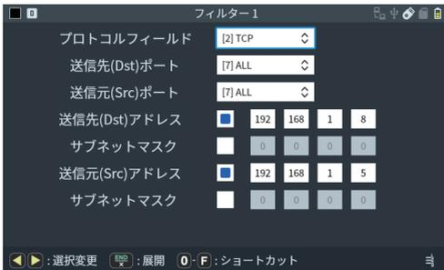
フィルター 0 で「装置 D → 装置 A」、フィルター 1 で「装置 A → 装置 D」の TCP フレームをモニターする条件にしています。この設定をポート A-B 用に設定します。
