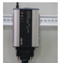
[ Onto 35mm DIN Rail ]
